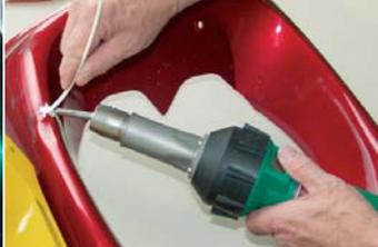
При использовании аппарата ТРИАК PID с электронной регулировкой температуры даже проблемный ремонт пластмассовых деталей не представляет трудностей.
