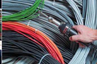
Аппарат ХОТ ДЖЕТ S с решетчатой рефлекторной насадкой при установке термоусадочной муфты.
