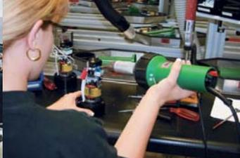
Усадка термоусадочного шланга при помощи аппарата ТРИАК PID.
