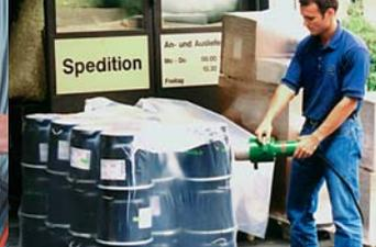
Усадка термоусадочной пленки на палетах перед транспортировкой при помощи аппарата ФОРТЕ S3. Отсутствие открытого пламени позволяет работать в небольших закрытых помещениях.
