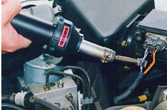
ХОТ ДЖЕТ S с паячной рефлекторной насадкой при усадке термоусадочной муфты.
