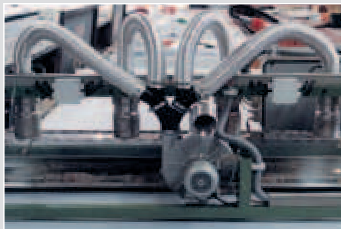
Сушка печати на текстильном полотне при помощи вентилятора и четырех нагревателей воздуха.
