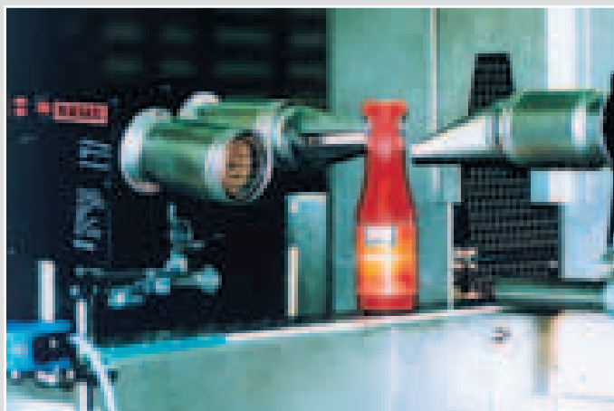
Тепловентилятор при усадке термоусадочных колпачков на бутылках.
