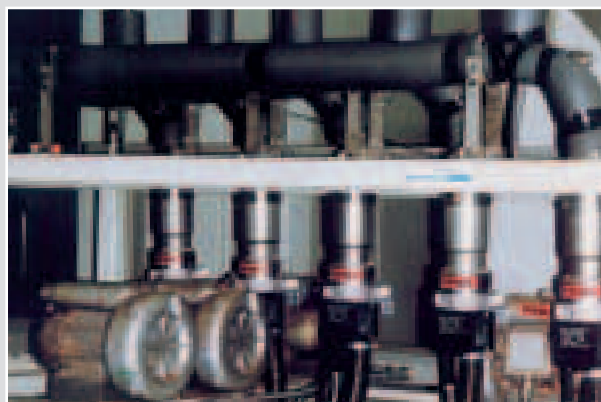
Нагреватели при подаче горячего воздуха в трубный канал. Стальные провода со специальным покрытием, проходя через канал, сплавляются.
