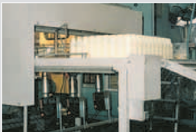
Тоннель для усадки, оснащенный тепловентиляторами, при усадке упаковочной пленки на громоздком товаре.
